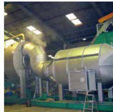
木屑炭化装置 キルン寸法：φ1760×7500L 炭化能力：木チップ 500kg/hr
