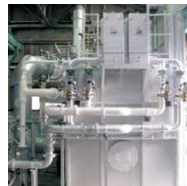
高性能鍛造炉 リジェネレータ：291KW×2台 加熱温度：1300℃ 炉内温度分布：±15℃ 炉内有効寸法：1500W×1500L×1200H
