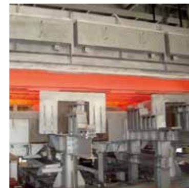
WB式鋳塊電気式加熱炉 常用温度：1000℃(max1050℃) 炉内寸法：1020W×4500L×550H
